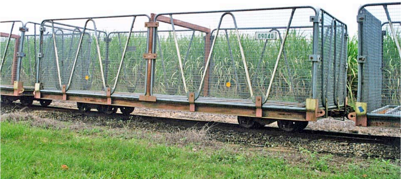
Victoria Mill 11 ton bogie bin
